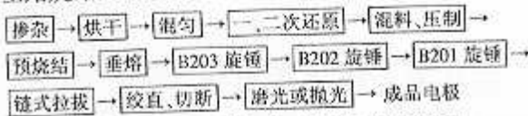
图 1 多元复合稀土钨电极的制备流程
