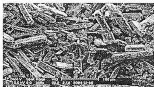
图 3 结晶温度 50 °C、搅拌 200 r/min 时的仲钨酸铵形貌
